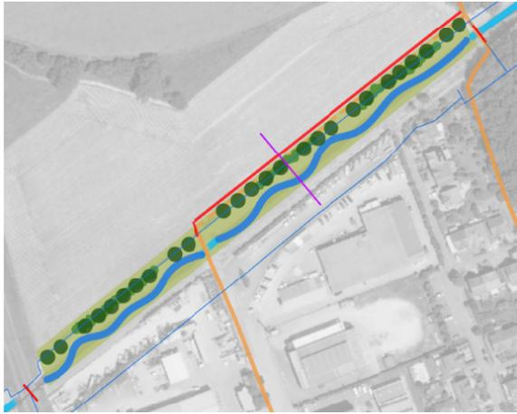
Figure 11: Aménagements prévus dans l'avant-projet pour la renaturation du tronçon BEY2.
